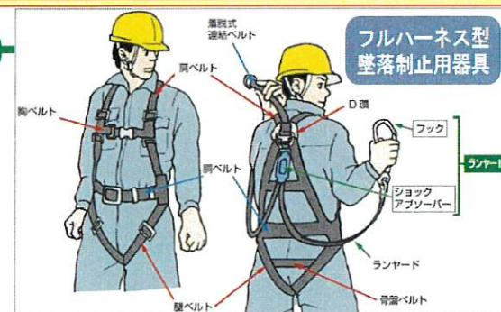
○ ただし、立木上での作業で、墜落制止用器具の使用が著しく困難な場合(フックがかけられない場合など)には、墜落制止用器具の使用に替わる措置として、U字つり用胴ベルト及び保護帽の使用などにより、墜落による労働災害の防止措置を行う必要があります。
